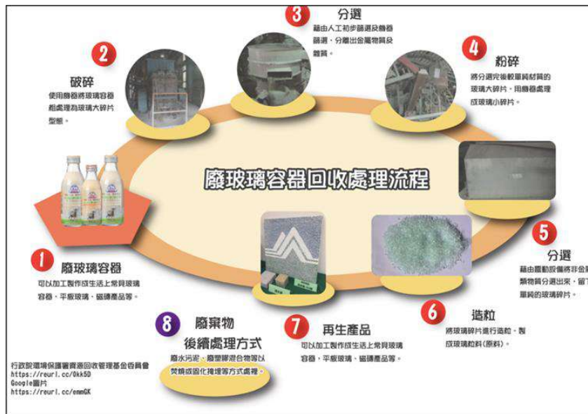
圖 2.1 廢玻璃容器回收處理流程 [2.1]
